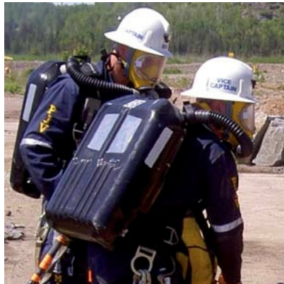
Slika 18. Aparati sa zatvorenim sustavom cirkulacije (na komprimirani kisik ili kemijski vezani kisik)
