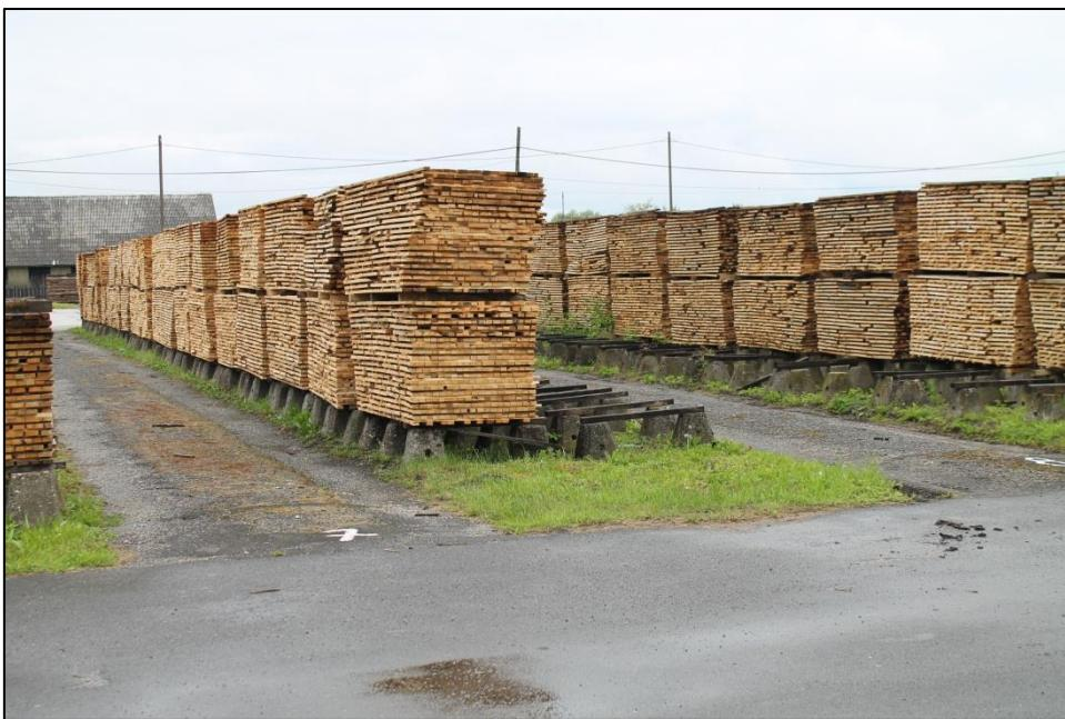
**Slika 34:** Palete piljene drvne građe pristupačne utovarivaču ili viličaru
