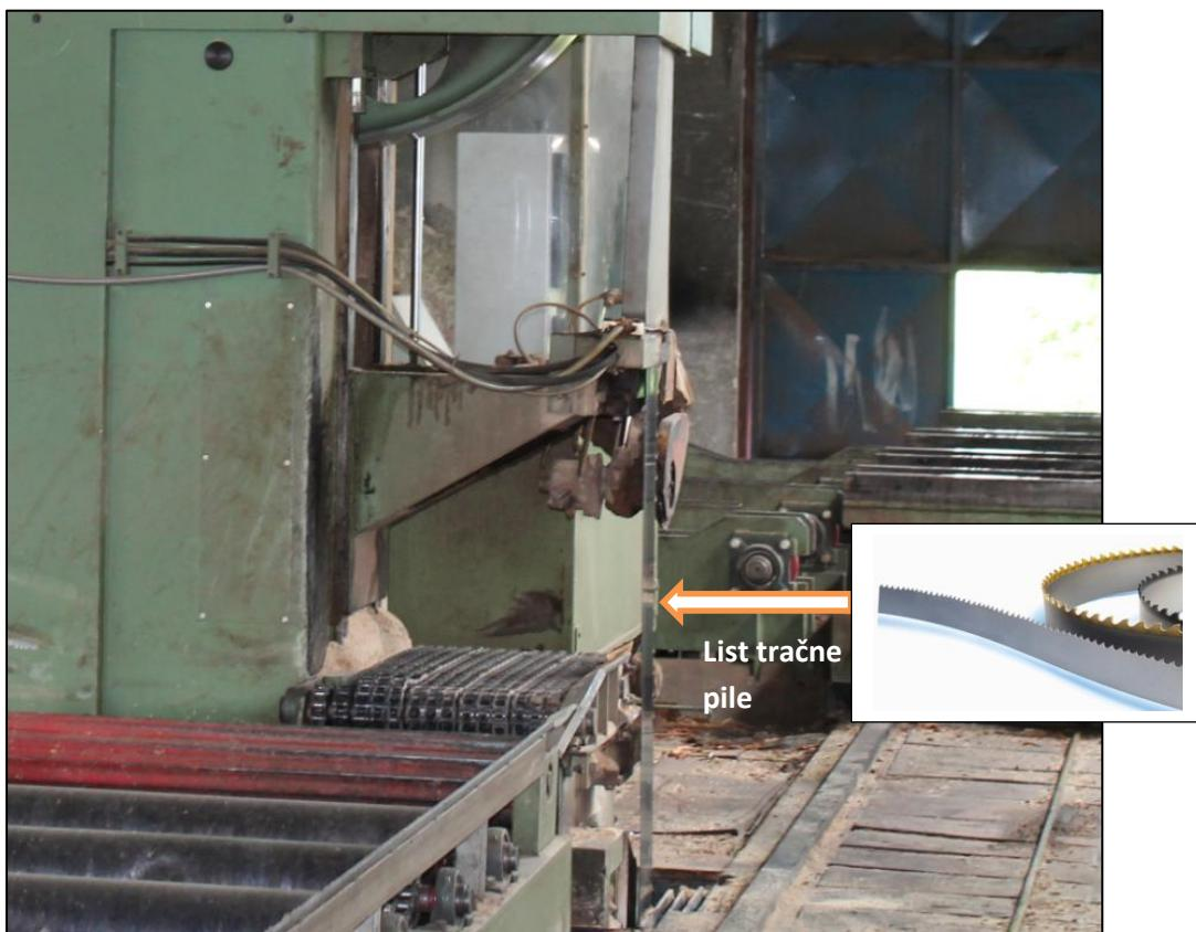
**Slika 28:** Tračna pila
