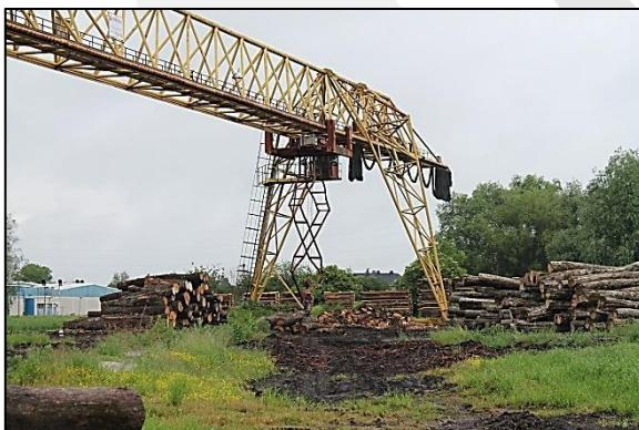
**Slika 19:** Portalna dizalica za prenošenje trupaca do pilane
