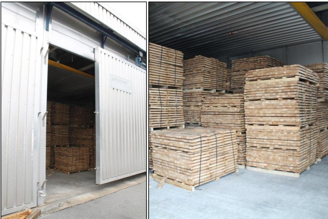
*Slika 36: Palete složene piljene građe unutar sušare*
