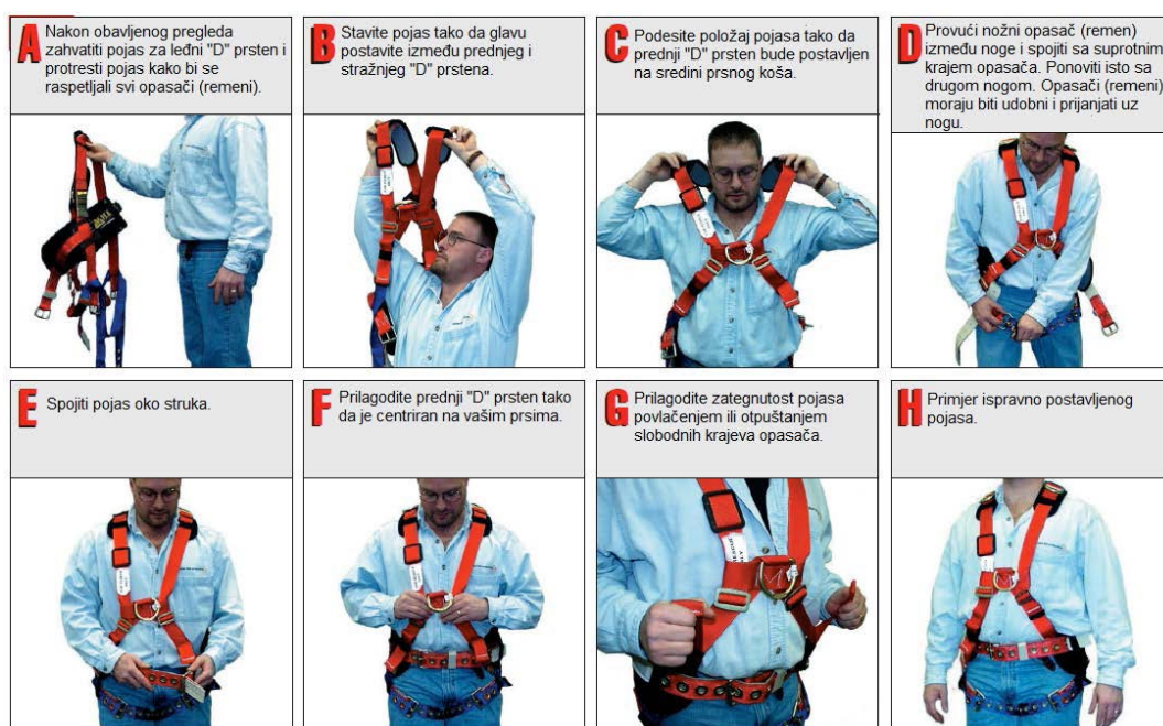
Slika 22. Primjer postupka postavljanja sigurnosnog pojasa
