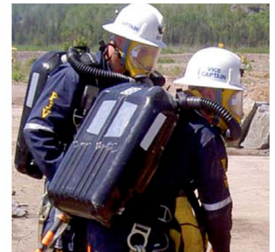
Slika 17. Aparati sa zatvorenim sustavom cirkulacije (na komprimirani kisik ili kemijski vezani kisik)
