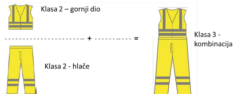
Slika 24. Primjer više i niže razine vidljivost s obzirom na retrorefleksivnost materijala
